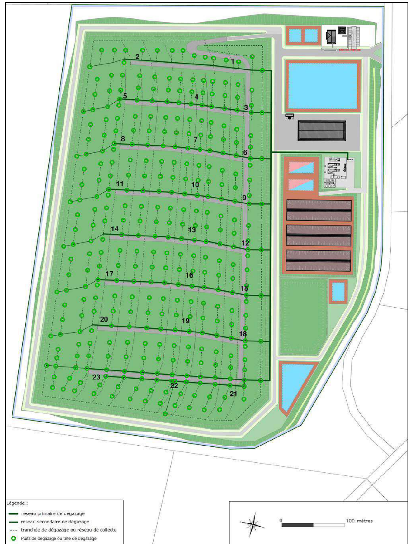
Réseau de drainage et de traitement des biogaz
