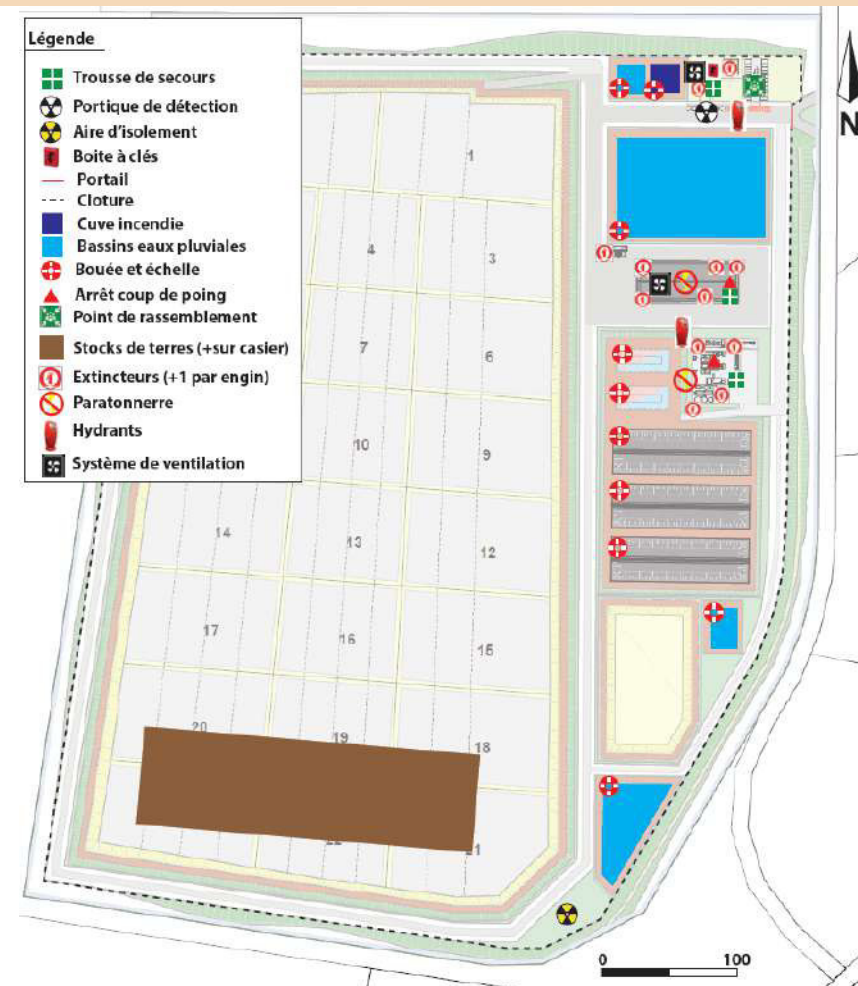
Localisation des principales mesures de sécurité
