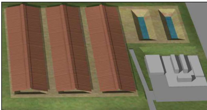
Toitures au dessus des lagunes de stockage des lixiviats
